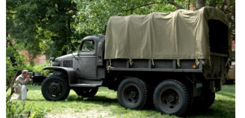
...genau gesagt der kurze GMC (CCKW-352), der als Protzfahrzeug für die leichte Feldhaubitze (beim ÖBH) verwendet wurde.
